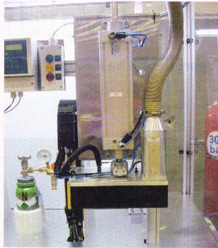
Prüfstation mit oberer und unterer Glocke
